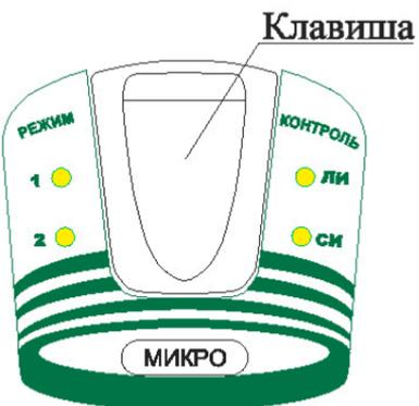
**Рис. 2. Панель с органами управления аппарата.**
